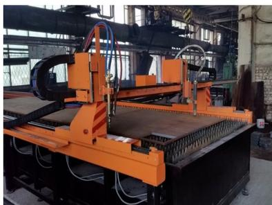
Портальная установка плазменной резки MaxPro200 и газовой резки Harris
