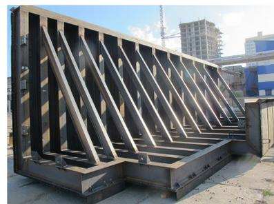
Сборка конструкций КЕССОНА для ООО «Спецгидрострой» г. Чайковский
